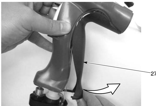
Рис. 5-8 Снятие накладки заземления
