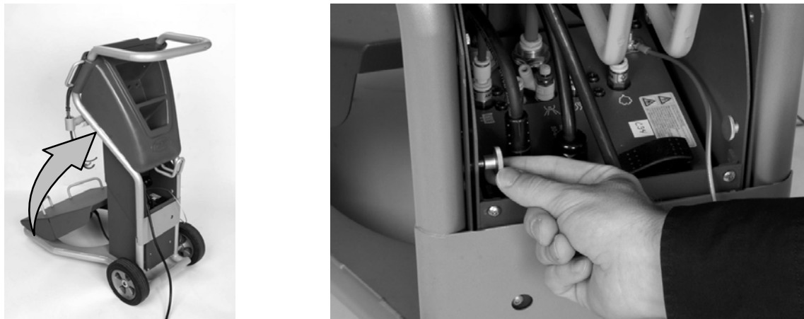
Рис. 2-5 Откидывание и закрепление на месте рукоятки тележки
