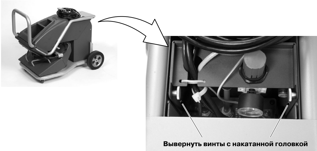
Рис. 2-4 Подготовка к откидыванию рукоятки тележки (показана система VBF)
