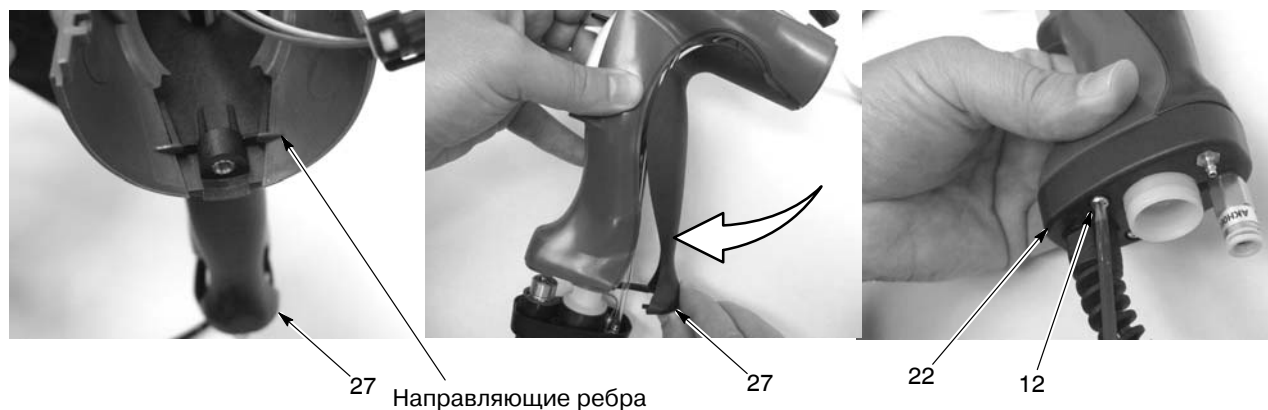
Рис. 5-12 Установка накладки заземления и основания на рукоятку
