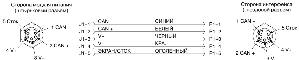
Рис. 4-5 Провода межмодульного соединительного кабеля блока управления
