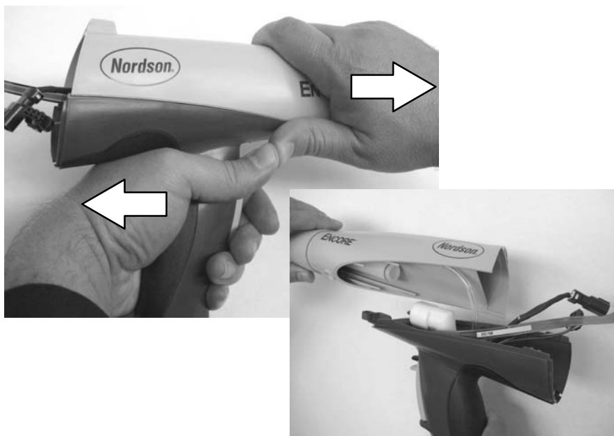
Рис. 5-6 Разъединение рукоятки и корпуса распылителя
