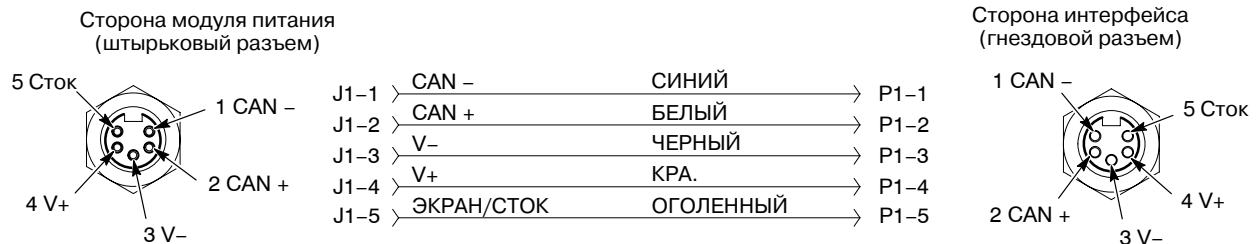
Рис. 4-5 Провода межмодульного соединительного кабеля блока управления
