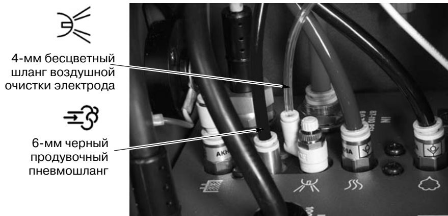
Рис. 2-11 Подсоединение к модулю питания шлангов воздушной очистки электрода и продувки
