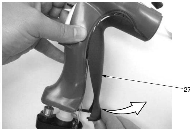
Рис. 5-8 Снятие накладки заземления
