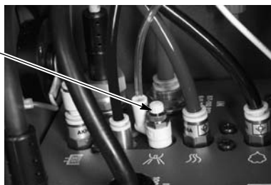
Obr. 3-4 Regulace fluidizačního vzduchu v mobilním systému
