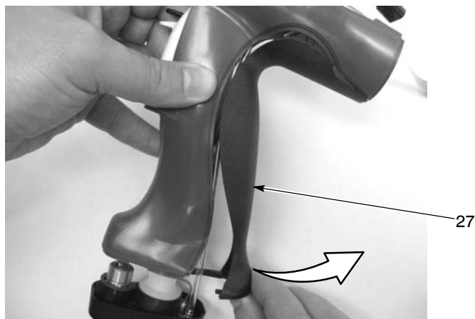
Obr. 5-8 Demontáž zemnicí podložky
