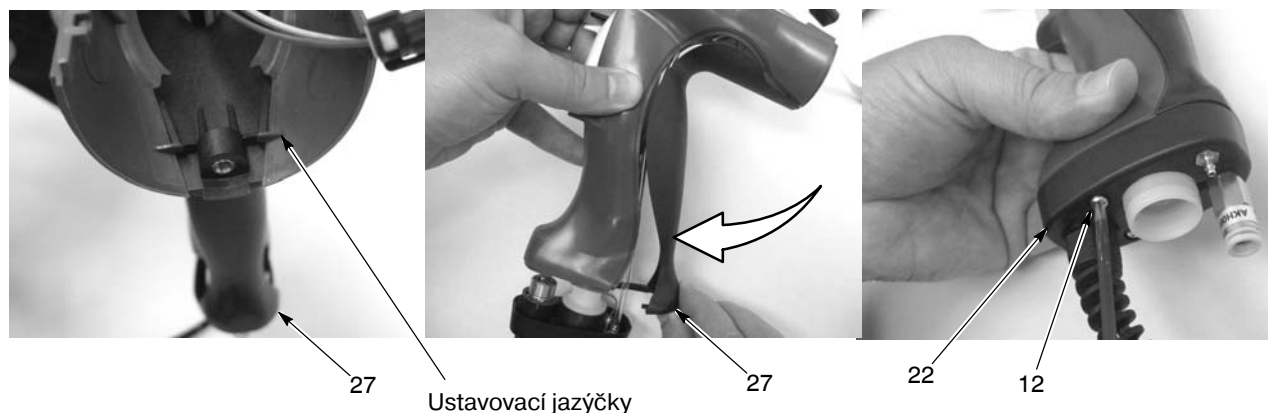
Obr. 5-12 Montáž zemnicí vložky a základny na poloviny rukojeti
