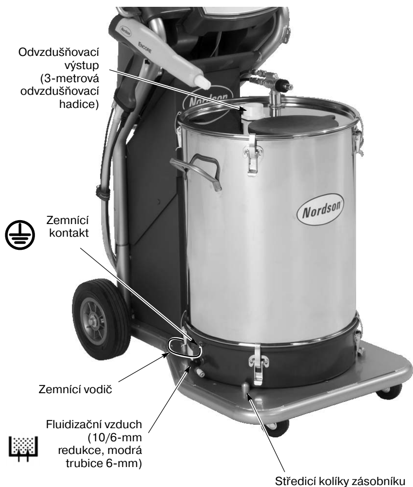
Obr. 2-6 Instalace zásobníku
