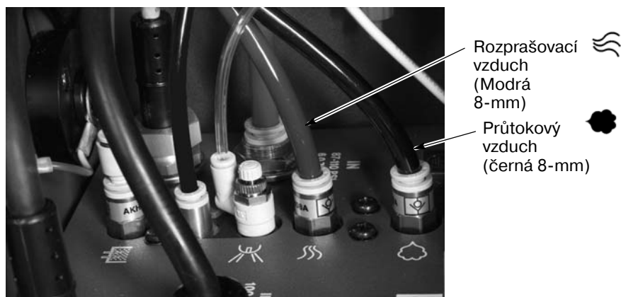
Obr. 2-9 Připojení průtokového a rozprašovacího vzduchu k napájecí jednotce
