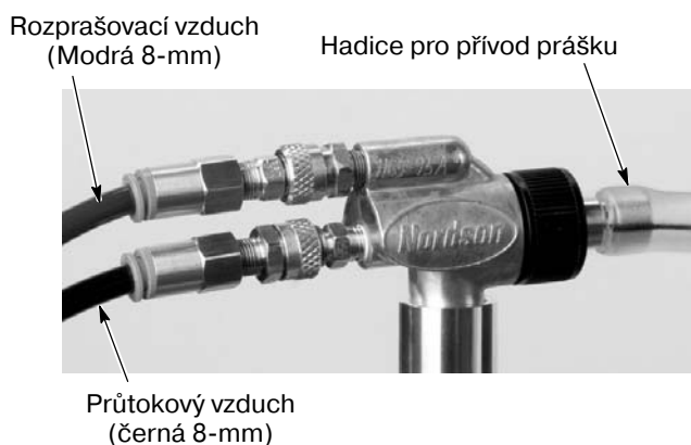
Obr. 2-8 Přípojky čerpadla
