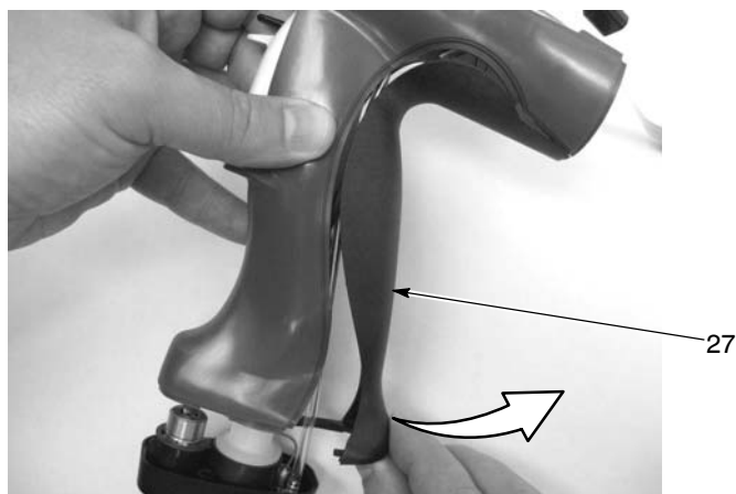
Obr. 5-8 Demontáž zemnicí podložky
