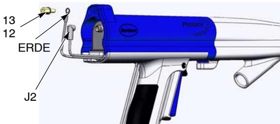
Abb. 21 Steuerungskabel abnehmen
