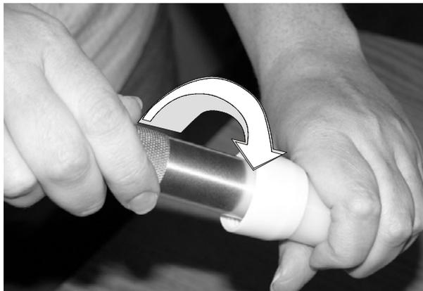
Abb. 7 Düse zerlegen, Schritt 2A
