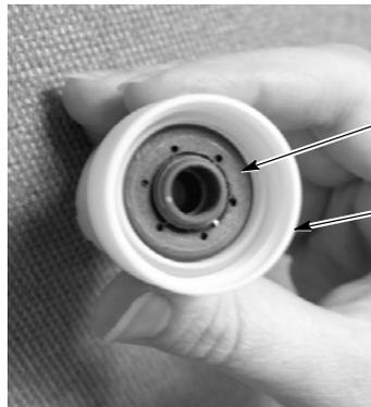
Abb. 10 Düse zusammensetzen
