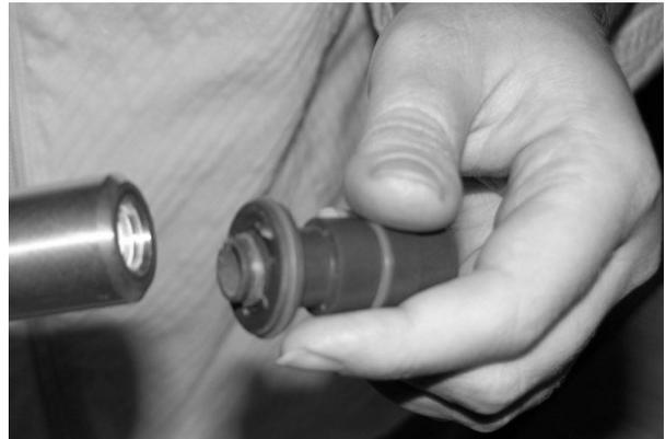
Abb. 9 Düse zerlegen, Schritt 3 (Abb. neuer Typ)
