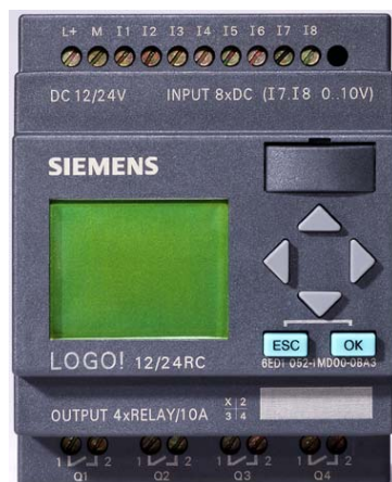
Abb. 10 SPS des Pulverzentrums
