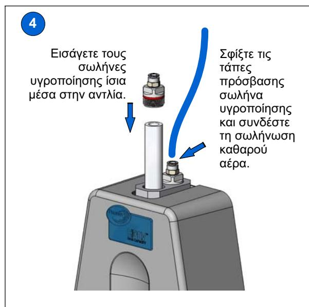
4 Εισάγετε τους σωλήνες υγροποίησης ίσια μέσα στην αντλία. Σφίξτε τις τάπες πρόσβασης σωλήνα υγροποίησης και συνδέστε τη σωλήνωση καθαρού αέρα.
