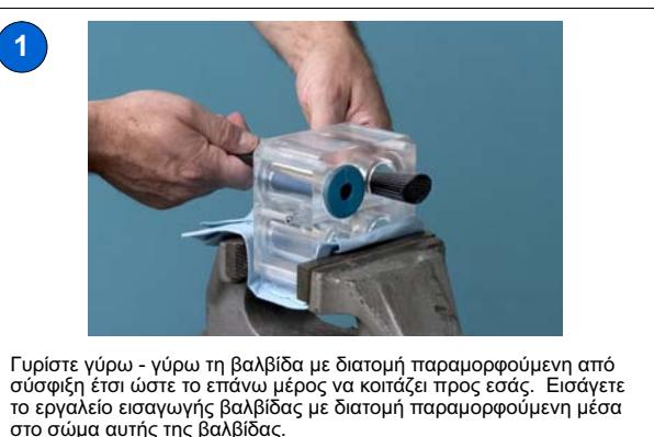
Γυρίστε γύρω - γύρω τη βαλβίδα με διατομή παραμορφούμενη από σύσφιξη έτσι ώστε το επάνω μέρος να κοιτάζει προς εσάς. Εισάγετε το εργαλείο εισαγωγής βαλβίδας με διατομή παραμορφουμένη μέσα στο σώμα αυτής της βαλβίδας.
