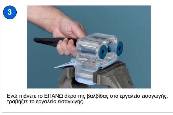
Ενώ πιάνετε το ΕΠΑΝΩ άκρο της βαλβίδας στο εργαλείο εισαγωγής, τραβήξτε το εργαλείο εισαγωγής.
