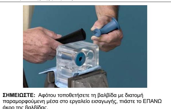
**ΣΗΜΕΙΩΣΤΕ:** Αφότου τοποθετήσετε τη βαλβίδα με διατομή παραμορφούμενη μέσα στο εργαλείο εισαγωγής, πιάστε το ΕΠΑΝΩ άκρο της βαλβίδας.
