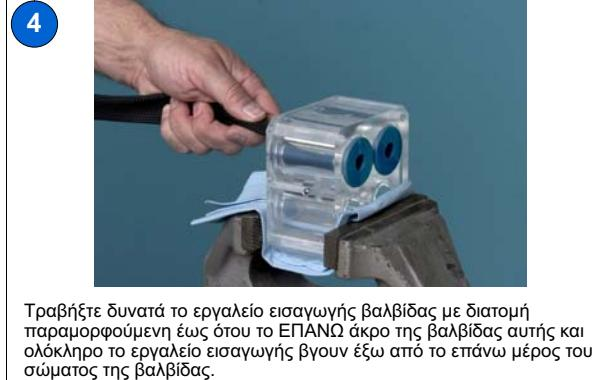
Τραβήξτε δυνατά το εργαλείο εισαγωγής βαλβίδας με διατομή παραμορφούμενη έως ότου το ΕΠΑΝΩ άκρο της βαλβίδας αυτής και ολόκληρο το εργαλείο εισαγωγής βγουν έξω από το επάνω μέρος του σώματος της βαλβίδας.
