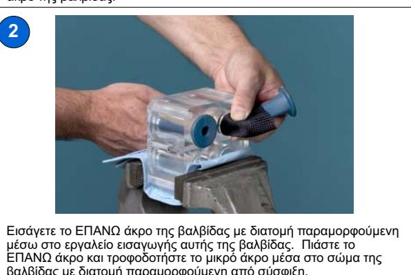
Εισάγετε το ΕΠΑΝΩ άκρο της βαλβίδας με διατομή παραμορφούμενη μέσω στο εργαλείο εισαγωγής αυτής της βαλβίδας. Πιάστε το ΕΠΑΝΩ άκρο και τροφοδοτήστε το μικρό άκρο μέσα στο σώμα της βαλβίδας με διατομή παραμορφούμενη από σύσφιξη.
