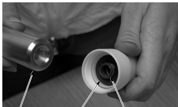
Obr.9 Rozmontování trysky Krok 2A
