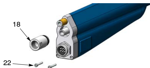
Obr.23 Odšroubování šroubů chladiče a pojistné matice
