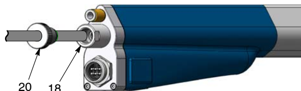
Obr.35 Odpojení práškové trubice
