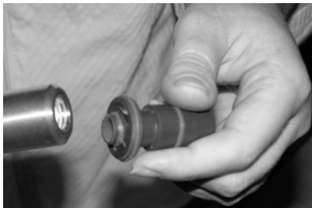
Obr. 11 Rozmontování trysky Krok 2B (zobrazena tryska nového typu)
