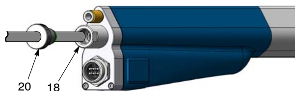
Obr.22 Odpojení práškové trubice
