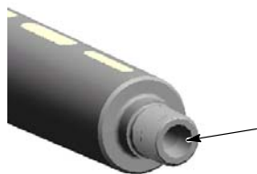
Obr.33 Mazání prohlubně násobiče - pistole upevněná pomocí trubky
