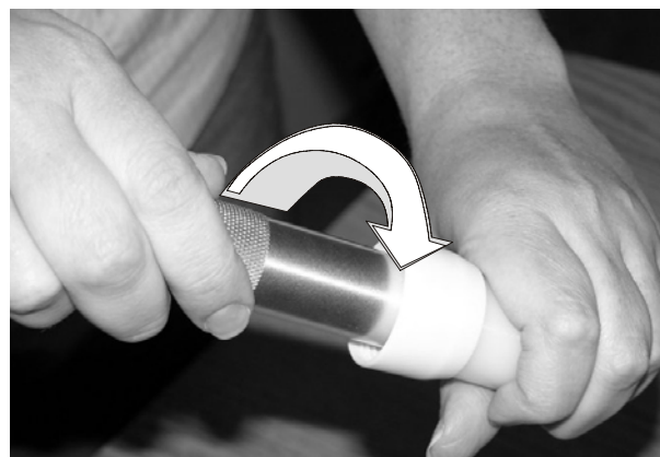
Obr.9 Rozmontování trysky Krok 2A
