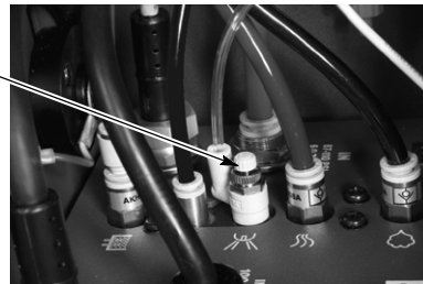
Slika 3-4 Regulacija fluidizirajućeg zraka mobilnog sustava
