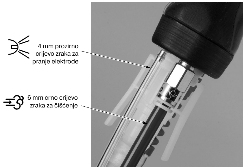
Slika 2-8 Spojite zračno i crijevo za prah na pištolj za raspršivanje
