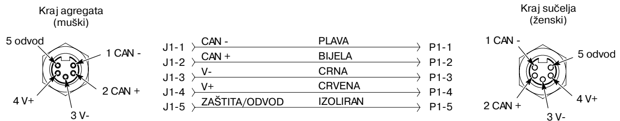
Slika 4-5 Ožičenje kabela za međusobno povezivanje upravljačkog sklopa
