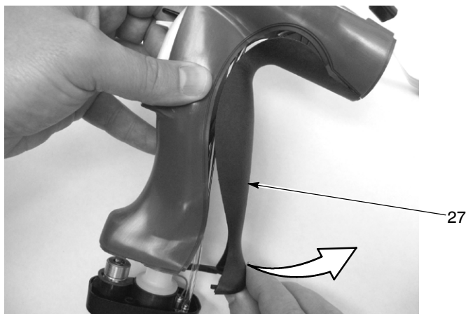
Slika 5-8 Skidanje podloge uzemljenja
