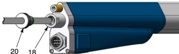
Fig. 35 Scollegamento del tubo polvere
