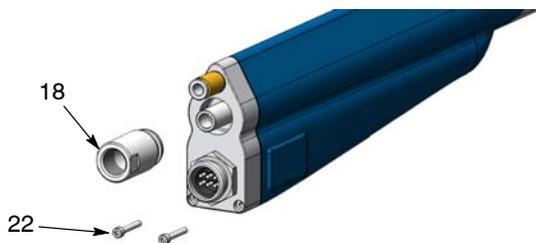
Fig. 36 Smontaggio delle viti del dissipatore di calore e del dado di bloccaggio
