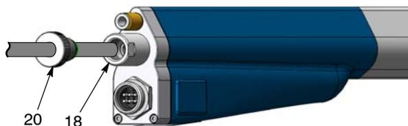
Fig. 22 Scollegamento del tubo polvere
