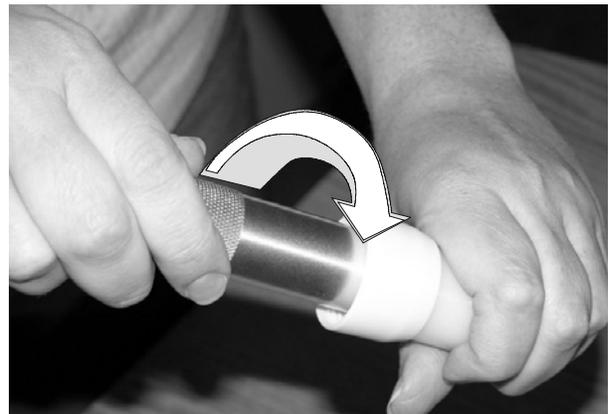
Fig. 9 Smontaggio dell'ugello – Punto 2A
