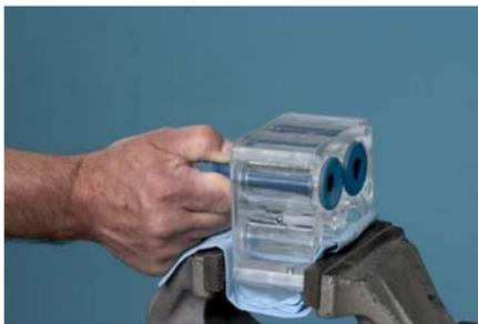
Mettere il corpo delle valvole a manicotto in una morsa imbottita con il lato inferiore di fronte a voi. Con una mano afferrate e tirate l'estremità inferiore della valvola a manicotto.
