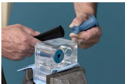
**NOTA:** Dopo aver messo la valvola nell'utensile d'inserimento, comprimere l'estremità SUPERIORE della valvola.
