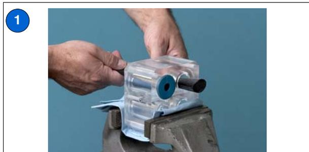
Rivoltare il corpo della valvola a manicotto di modo da avere di fronte il lato superiore. Introdurre l'utensile di inserimento della valvola nel corpo delle valvole a manicotto.
