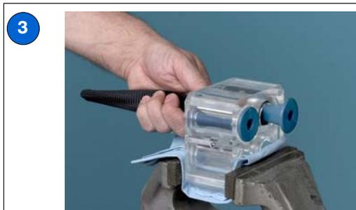
Mentre si comprime l'estremità SUPERIORE della valvola nell'utensile di inserimento, tirare l'utensile stesso.
