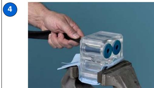
Tirare con fermezza l'utensile di inserimento della valvola a manicotto, finché l'estremità SUPERIORE della valvola e l'intero utensile escono dal lato superiore del corpo delle valvole a manicotto.
