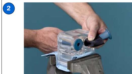
Inserire l'estremità SUPERIORE della valvola nell'utensile per l'inserimento della valvola a manicotto. Comprimere l'estremità SUPERIORE e introdurre l'estremità piccola nel corpo delle valvole a manicotto.
