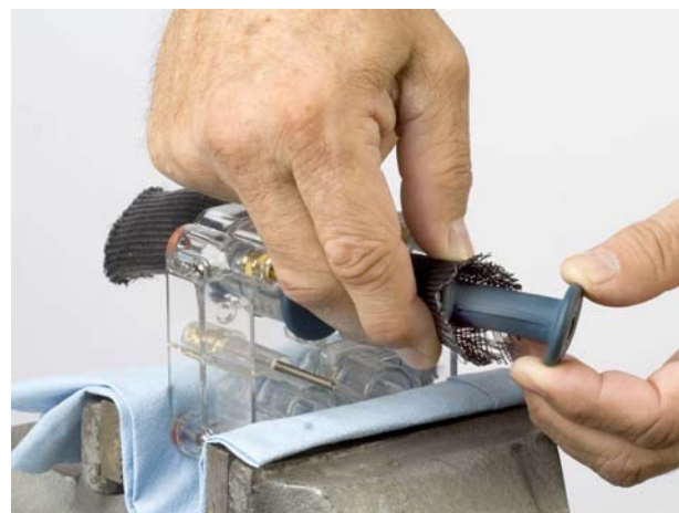
Figura 13 Inserimento della valvola a manicotto nell'utensile di inserimento
