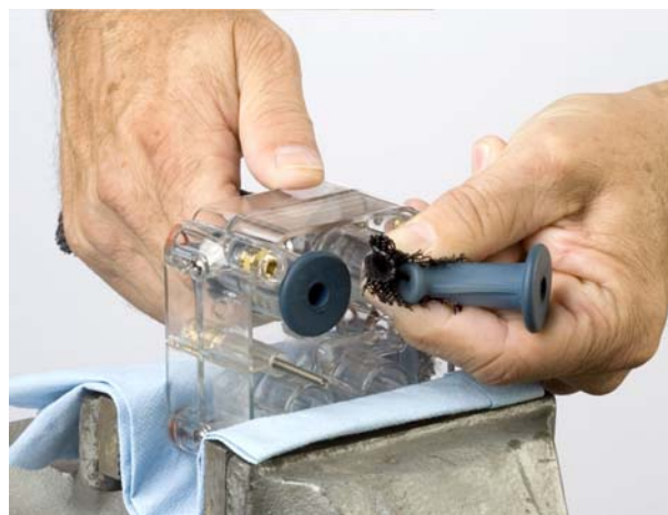
Bild 4 Hopklämning av strypventilens UP fläns
