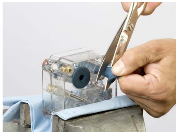
Bild 2 Demontering av strypventil
