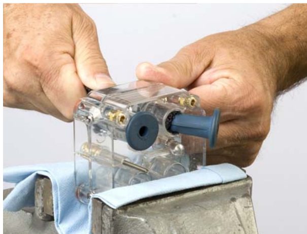
Bild 5 Indragning av strypventilen i ventilkroppen.
