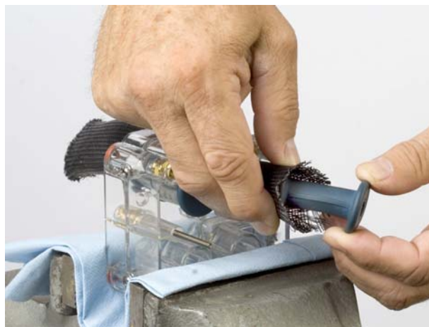
Bild 3 Påsättning av strypventil på installationsverktyget.
