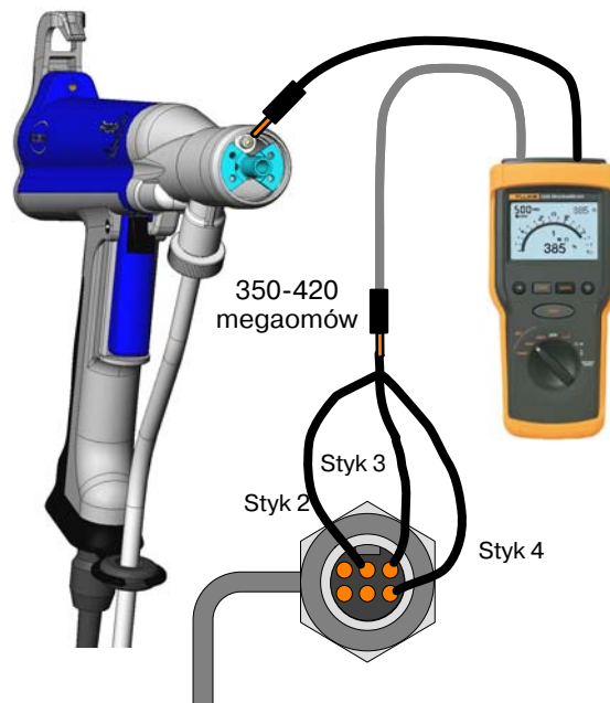
Rysunek 12 Test między końcem kabla i nurnikiem sprężyny
