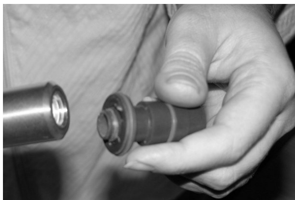
Rysunek 9 Etap 3 rozmontowywania dyszy (pokazano zespół nowego typu)
