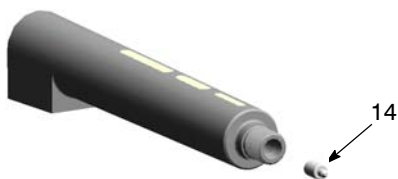
Rysunek 28 Wyjmowanie przewodzącej podkładki dystansowej
