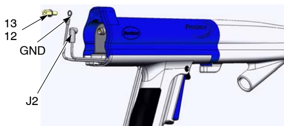
Rysunek 21 Odłączenie kabla sygnałowego
