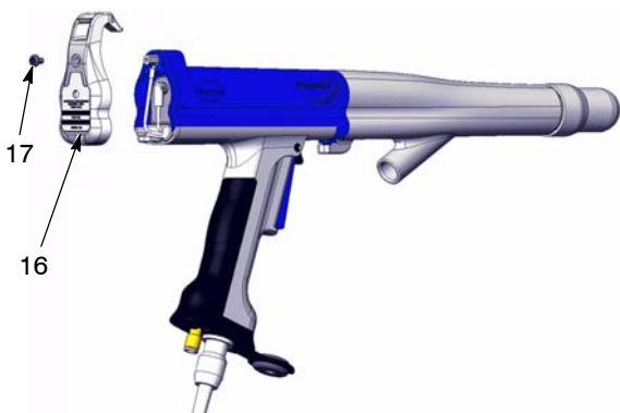
Rysunek 20 Zdejmowanie tylnej części korpusu pistoletu
