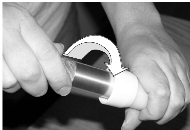
Rysunek 7 Etap 2A rozmontowywania dyszy
