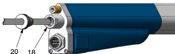
Bild 22 Demontering av pulverslang
