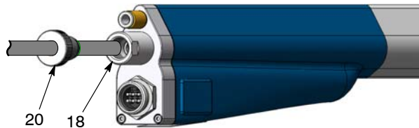
Bild 35 Demontering av pulverslang
