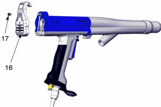
Bild 20 Demontering av lock över pistolände.
