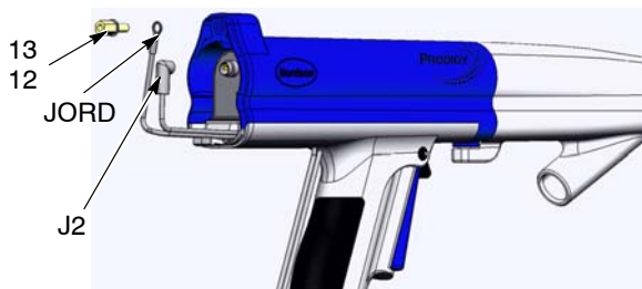
Bild 21 Demontering av styrkabel
