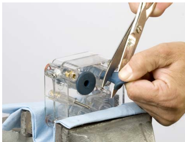
Bild 12 Demontering av strypventil
