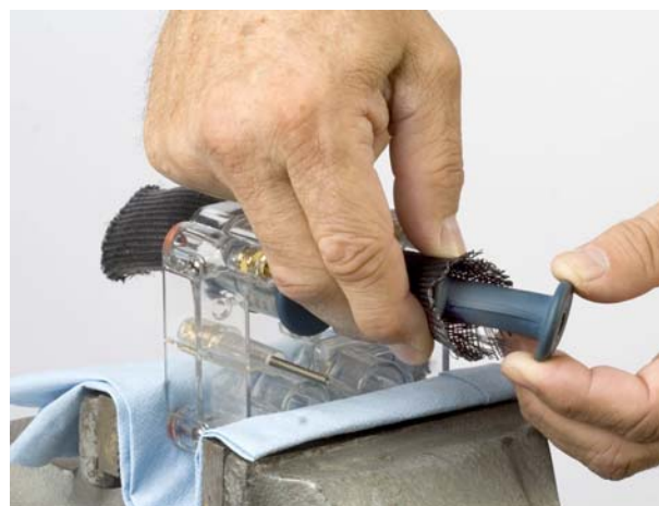
Bild 13 Påsättning av strypventil på installationsverktyget.
