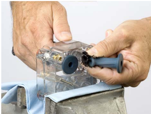
Bild 14 Hopklämning av strypventilens UP fläns
