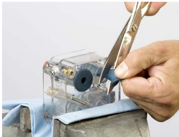
Bild 12 Demontering av strypventil
