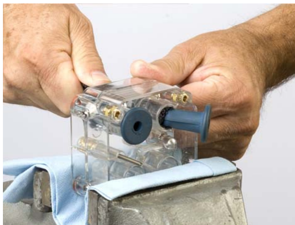
Bild 15 Indragning av strypventilen i ventilkroppen.
