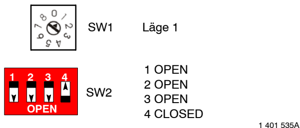
Bild 4 Inställning av omkopplarna SW1 och SW2 vid ett manuellt pulverstraysystem
