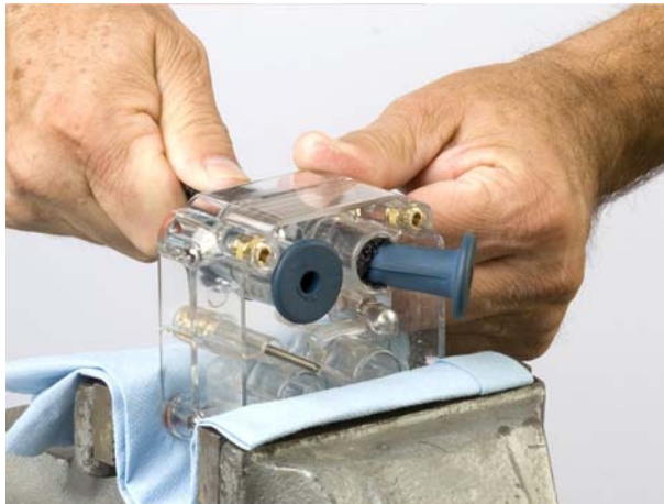
Abbildung 15 Ziehen des Schlauchquetschventils in den Verteilerblock
