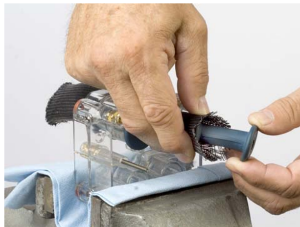
Abbildung 13 Einführen des Schlauchquetschventils in das Einsetzwerkzeug
