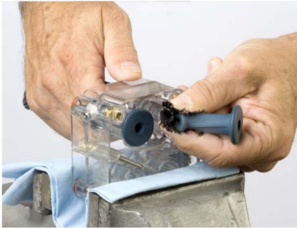
Abbildung 14 Mit UP markierten Flansch des Ventils plattdrücken
