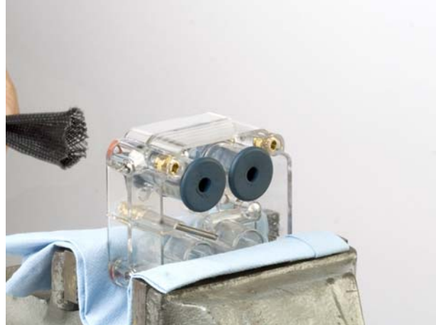
Abb. 16 Pfropfenförderventil durch das Ventilgehäuse ziehen
