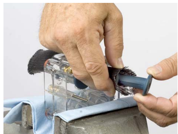
Abb. 13 Pfropfenförderventil in das Einsteckwerkzeug einsetzen
