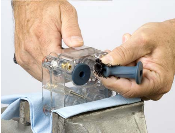
Abb. 14 Mit UP markierten Flansch des Ventils plattdrücken
