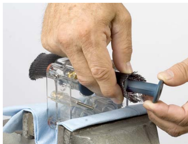
Figura 13 Introducerea supapei de efilare în dispozitivul de inserție
