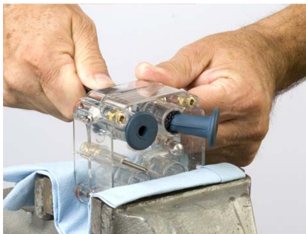
Figura 15 Tragerea supapei de efilare în corpul supapei
