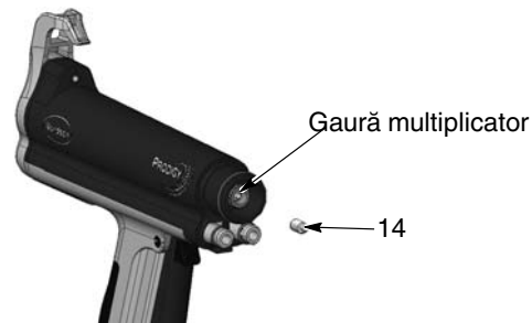
Figura 26 Îndepărtarea distanțierului de contact
