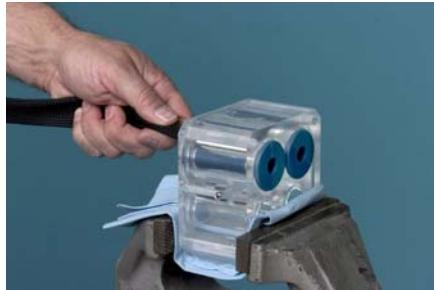
С силой тянуть монтажное приспособление для пережимных клапанов, пока ВЕРХНИЙ (UP) конец клапана и все монтажное приспособление не выйдет из корпуса клапанов.
