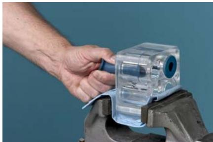
С силой тянуть пережимной клапан, пока он не выйдет из корпуса клапанов.
