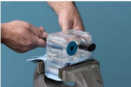
Повернуть корпус пережимных клапанов верхней стороной к себе. Вставить в корпус клапанов приспособление для монтажа пережимных клапанов.
