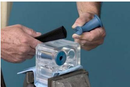
**ПРИМЕЧАНИЕ:** Вставив пережимной клапан в монтажное приспособление, сдавить ВЕРХНИЙ (UP) конец клапана.
