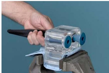
Втянуть монтажное приспособление, сжимая в нем ВЕРХНИЙ (UP) конец пережимного клапана.
