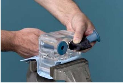
Вставить ВЕРХНИЙ (UP) конец пережимного клапана в приспособление для монтажа пережимных клапанов. Сдавив ВЕРХНИЙ (UP) конец, ввести его малый край в корпус пережимных клапанов.
