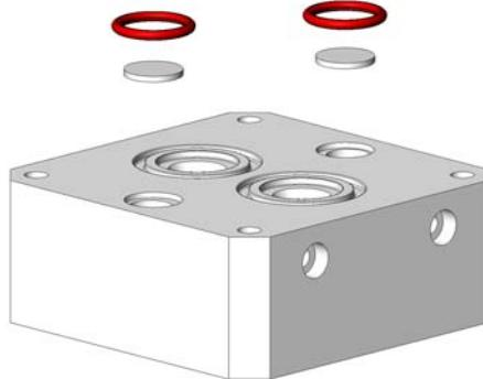
Снимите с насоса старые дисковые фильтры и уплотнительные кольца. Поставьте новые дисковые фильтры и уплотнительные кольца из комплекта пережимных клапанов.
