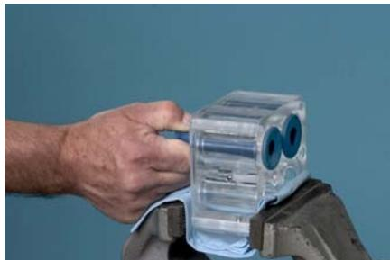
Зажать корпус пережимных клапанов в тисках с мягкими накладками на губках нижней стороной к себе. Зажать и оттянуть одной рукой нижний конец пережимного клапана.
