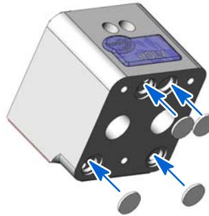
Снять старые дисковые фильтры с корпуса насоса и поставить новые дисковые фильтры.
