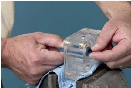
Другой рукой сдавить противоположный конец пережимного клапана.
