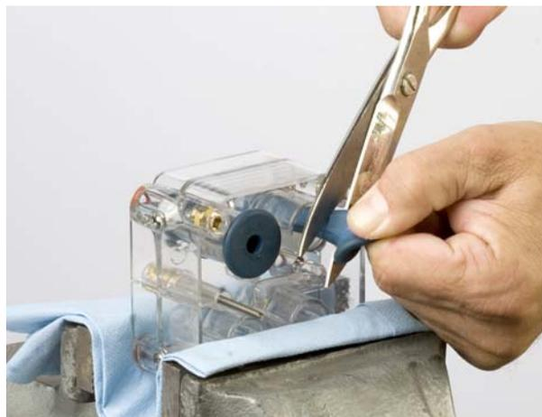
Рис. 12 Демонтаж пережимного клапана
