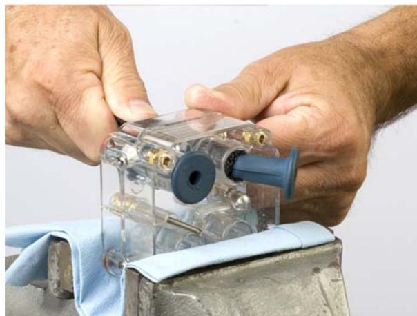
Рис. 15 Втягивание пережимного клапана в коллектор клапанов
