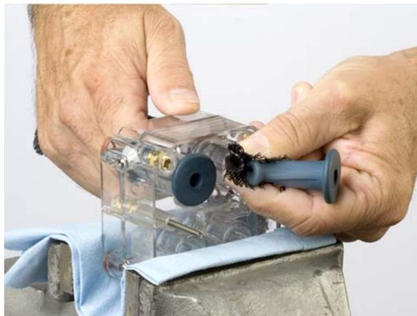
Рис. 14 Сдавливание до плоского состояния фланца UP пережимного клапана
