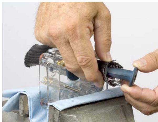
Рис. 13 Установка пережимного клапана в монтажный инструмент
