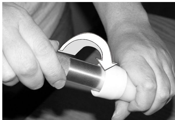
Рис. 4 Разборка форсунки, операция 2А
