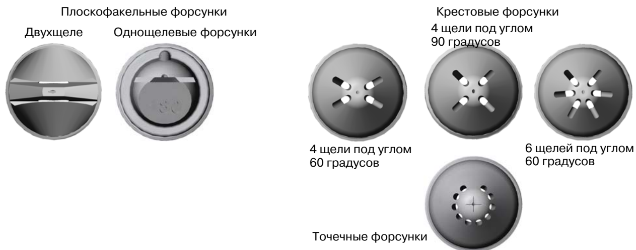
Рис. 30 Плоскофакельные, крестовые и точечные форсунки
