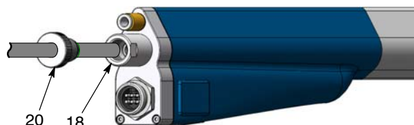
Рис. 35 Отсоединение порошкового шланга
