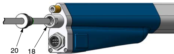
Рис. 22 Отсоединение порошкового шланга
