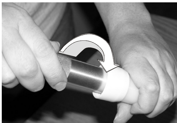
Рис. 9 Разборка форсунки, операция 2А
