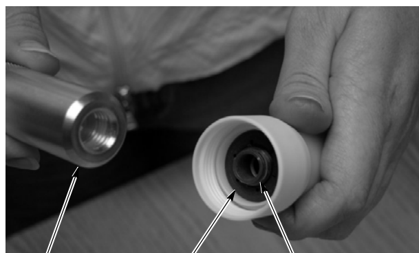
Инструмент Кольцо электрода Втулка
