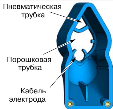
Рис. 41 Отверстия для ввода пневматической трубки, порошковой трубки и кабеля электрода
