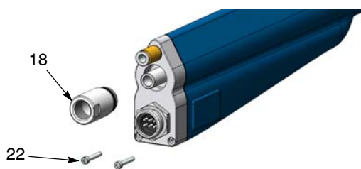
Рис. 23 Отворачивание винтов теплоотвода и стопорной гайки
