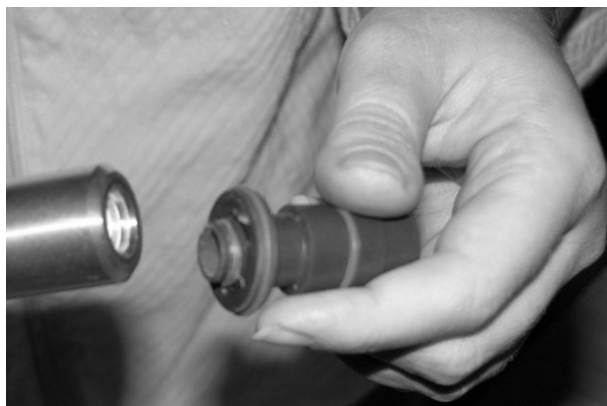
Рис. 11 Разборка форсунки, операция 2В (показана форсунка нового типа)
