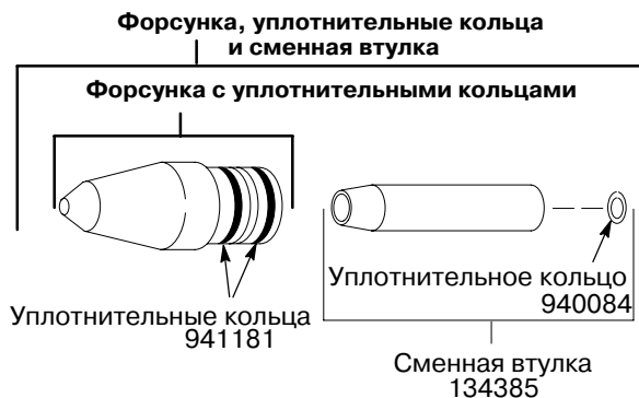
Рис. 15 Общие детали плоскофакельной форсунки
