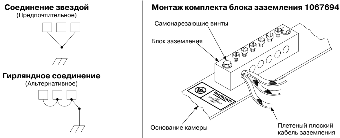
Рис. 3-9 Методы и средства заземления ESD
