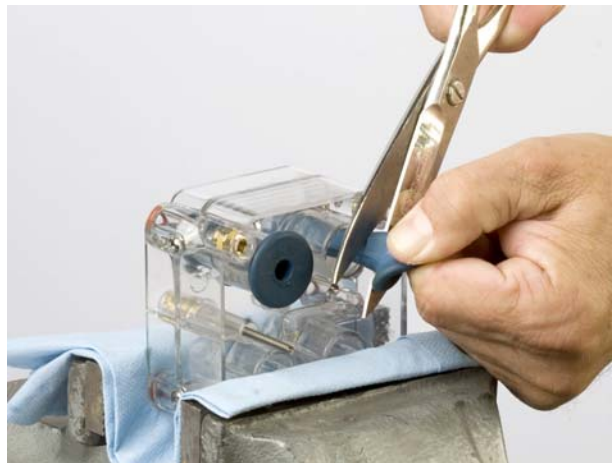
Figure 12 Dépose de la valve à étranglement
