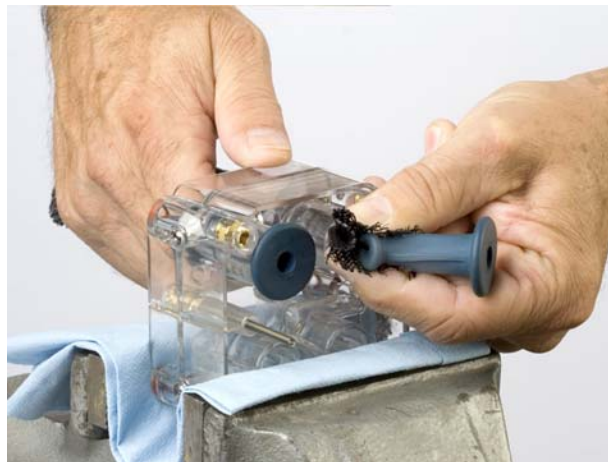
Figure 14 Aplatissement de la bride UP de la valve à étranglement
