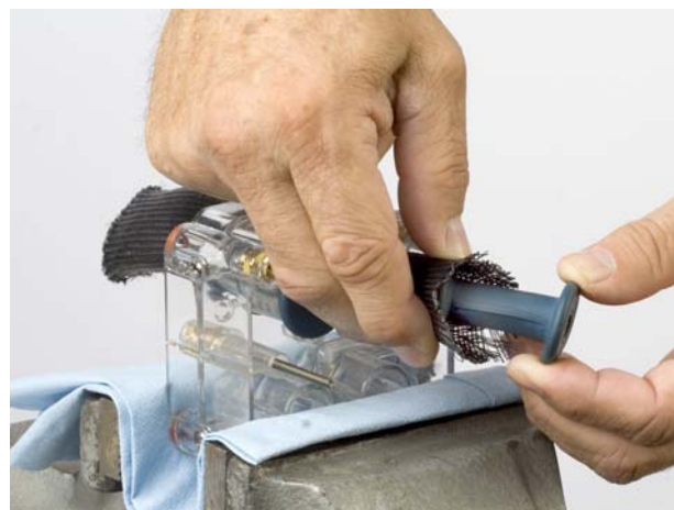
Figure 13 Insertion de la valve à étranglement dans l'outil d'insertion
