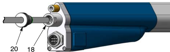
Fig. 35 Déconnexion du tuyau à poudre
