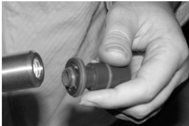
Fig. 11 Étape 2B du démontage de la buse (buse nouveau modèle illustrée)
