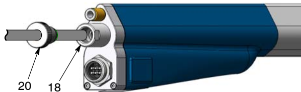
Fig. 22 Déconnexion du tuyau à poudre
