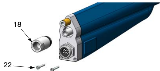
Fig. 23 Dépose du dissipateur thermique et de l'écrou de blocage
