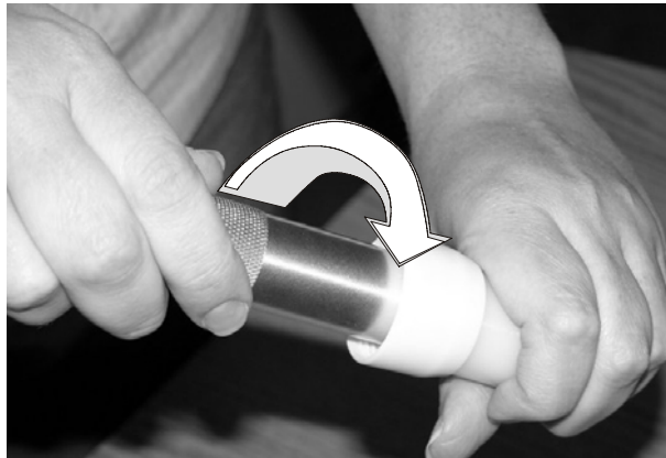
Obr.6 Rozmontování trysky Krok 3 (zobrazen nový typ)
