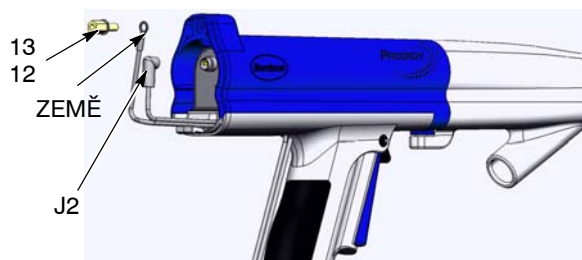
Obr. 18 Odpojení ovládacího kabelu
