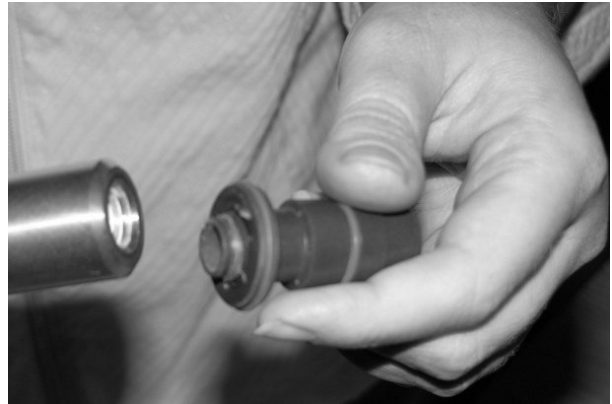
Obr.6 Rozmontování trysky Krok 3 (zobrazen nový typ)
