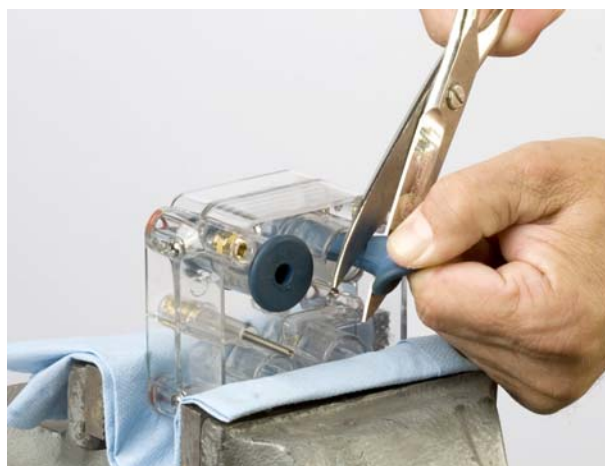
Obr. 12 Demontáž škrticího ventilu
