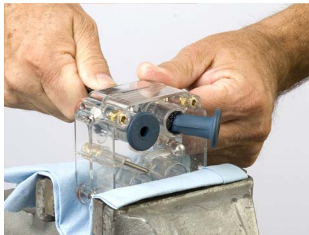
Obr. 15 Zatažení škrticího ventilu do tělesa ventilů
