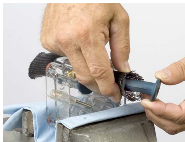
Obr. 13 Vložení škrticího ventilu do zasouvacího nástroje
