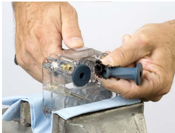
Obr. 14 Zploštění příruby UP škrticího ventilu
