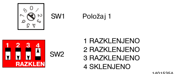
Slika 4 Nastavitve stikal SW1 in SW2 za sisteme za ročno prašno lakiranje
