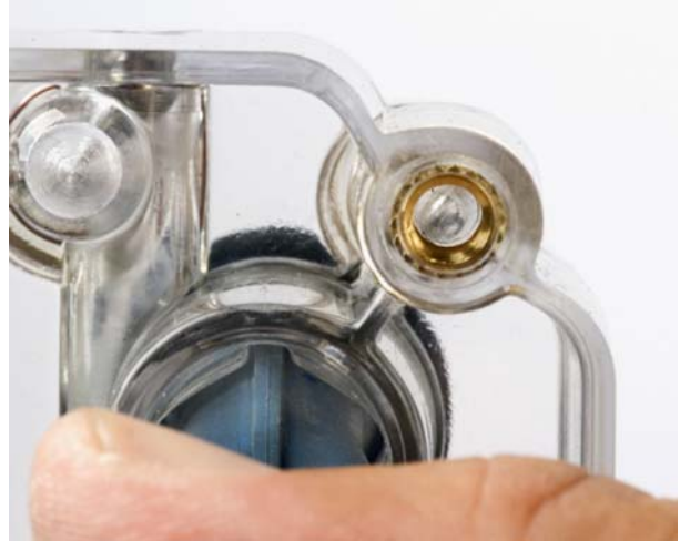
Slika 7 Odstranjevanje ščipalnega ventila
