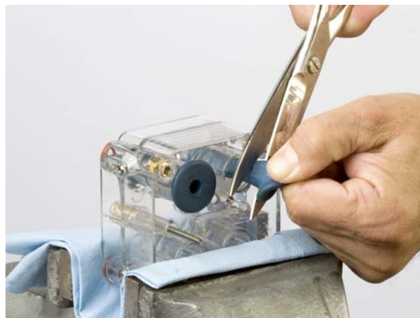
Slika 2 Odstranjevanje ščipalnega ventila
