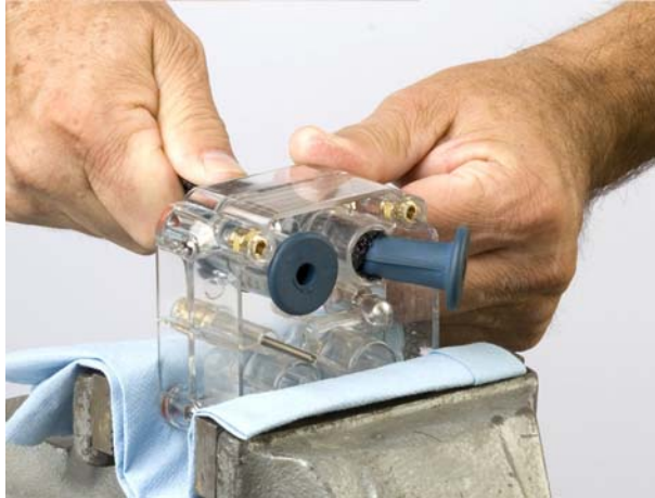
Slika 5 Poteg ščipalnega ventila v ohišje ventilov
