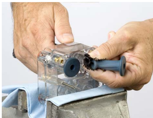
Slika 4 Stiskanje prirobnice UP na ščipalnem ventilu
