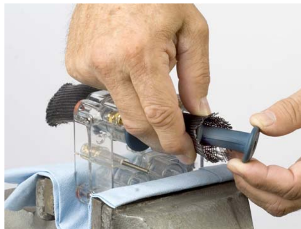
Slika 3 Vstavljanje ščipalnega ventila v orodje za vstavljanje
