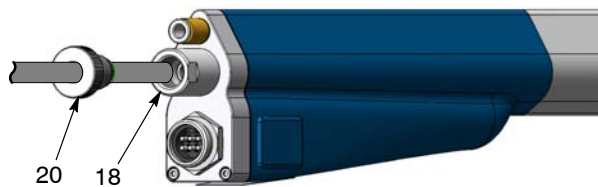
Figura 22 Desconexión del tubo de polvo
