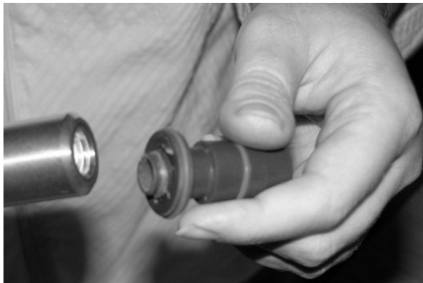
Figura 11 Desmontaje boquilla paso 2B (Boquilla de nuevo diseño mostrada)
