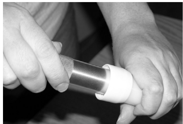
Figura 9 Desmontaje de la boquilla paso 2A
