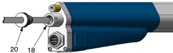
Figura 35 Desconexión del tubo de polvo
