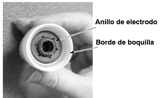
Figura 12 Remontaje de boquilla
