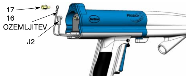
Slika 19 Odklapanje nadzornega kabla
