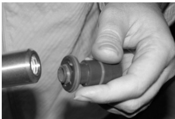
Slika 7 Razstavljanje šobe, korak 3 (prikazana je novejša izvedba)
