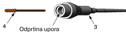
Slika 25 Odstranjevanje upora iz držala
