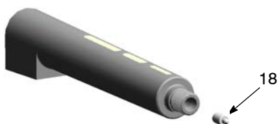
Slika 27 Odstranjevanje kontaktne podložke
