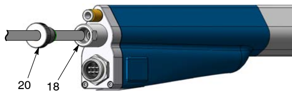
Fig. 22 Frakobling af pulverslange
