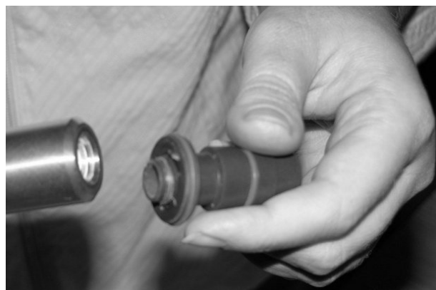
Fig. 11 Adskillelse af dyse Trin 2B (billedet viser ny dysetype)
