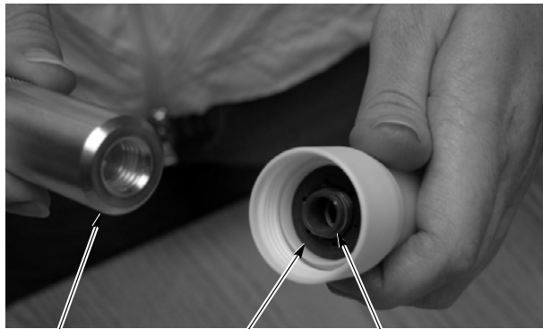
Værktøj Elektrodering Indsats Fig. 8 Adskillelse af dyse Trin 1 (vist med dyse monteret)
