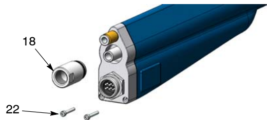
Fig. 23 Afmontering af skruer til varmeafleder og sikringsmøtrik
