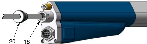
Fig. 35 Frakobling af pulverslange
