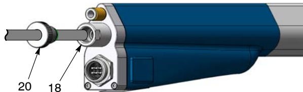
Afb. 35 Loshalen van de poederslang
