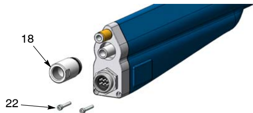
Afb. 23 Verwijderen van koellichaamschroeven en borgmoer
