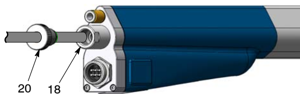
Afb. 22 Loshalen van de poederslang
