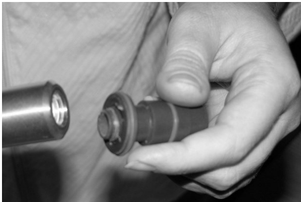
Afb. 11 Stap 2B bij demontage spuitmond (nieuw type spuitmond afgebeeld)
