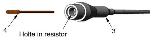
Afb. 25 Verwijderen van resistor uit de resistorhouder
