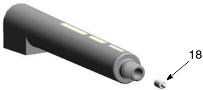
Afb. 27 Verwijderen van het contactstuk
