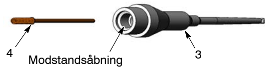
Fig. 25 Afmontering af modstanden fra holderen
