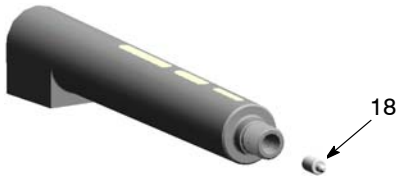
Fig. 27 Afmontering af mellemstykket
