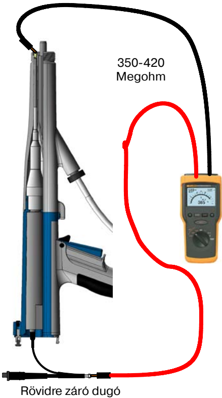
Ábra 4 Próbálja le rövidre záró dugóval
