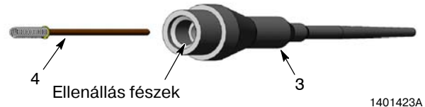
Ábra 18 Az ellenállás kivétele a tartójából
