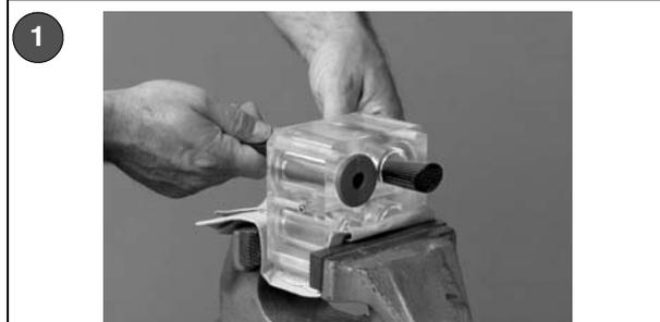
Girar el cuerpo de la válvula peristáltica para que el extremo superior quede mirando hacia Ud. Introducir la herramienta de inserción de la válvula peristáltica en el cuerpo de la válvula peristáltica.
