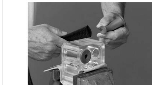
**OBSERVACION:** Después de colocar la válvula peristáltica en la herramienta de inserción, pellizcar el extremo ARRIBA de la válvula.
