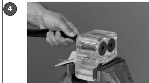
Extraer la herramienta de inserción de la válvula peristáltica con firmeza hasta que el extremo ARRIBA de la válvula peristáltica y la herramienta de inserción entera salgan de la parte superior del cuerpo de la válvula peristáltica.
