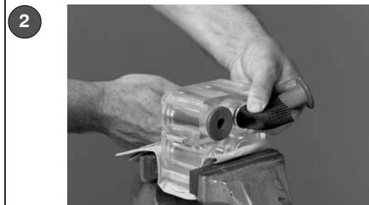
Introducir el extremo ARRIBA de la válvula peristáltica en la herramienta de inserción de la válvula peristáltica. Pellizcar el extremo ARRIBA e introducir el extremo pequeño en el cuerpo de la válvula peristáltica.
