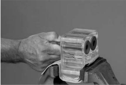
Colocar el cuerpo de la válvula peristáltica en un tornillo de banco acolchado con el extremo inferior mirando para Ud. Agarrar y extraer el extremo inferior de la válvula peristáltica con una mano.
