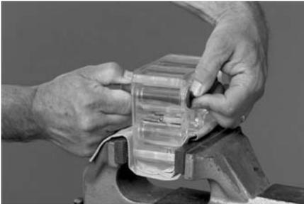
Utilizar la otra mano para pellizcar el extremo opuesto de la válvula peristáltica.
