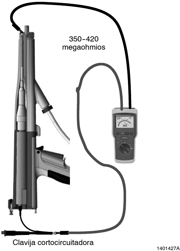
Fig. 4 Prueba con la clavija cortocircuitadora
