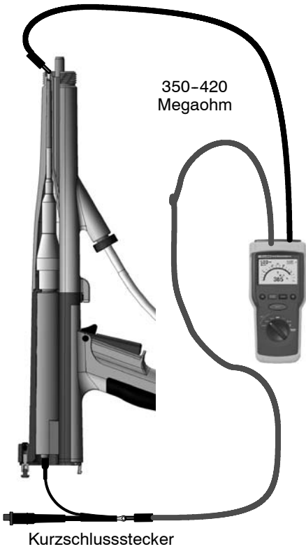
Abb. 4 Prüfung mit Kurzschlussstecker
