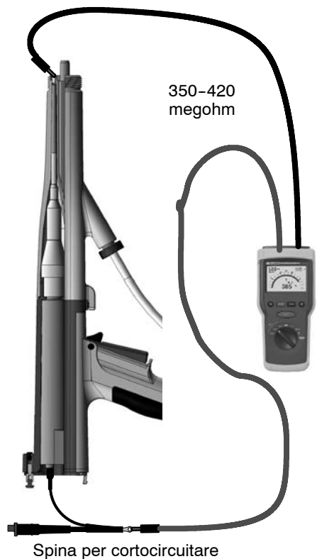
Fig. 4 Prova con spina per cortocircuitare
