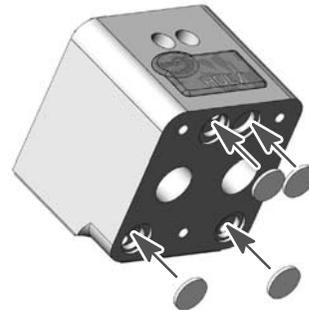
Retirez les disques filtrants usagés du corps de la pompe et montez les disques neufs.
