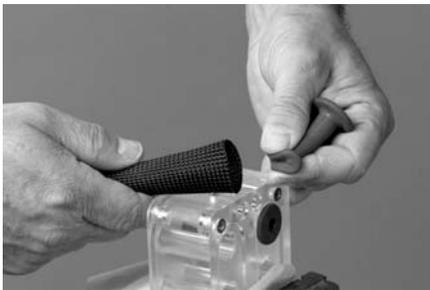
**REMARQUE :** Après avoir placé la valve à étranglement dans l'outil d'insertion, pincez l'extrémité SUPÉRIEURE de la valve.
