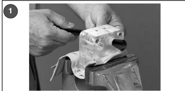
1 Tournez le corps de la valve à étranglement pour amener le dessus face à vous. Insérez l'outil d'insertion de la valve à étranglement dans le corps de celle-ci.
