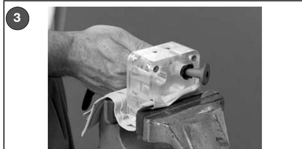
3 Retirez l'outil d'insertion tout en pinçant l'extrémité SUPÉRIEURE de la valve à étranglement dans l'outil.
