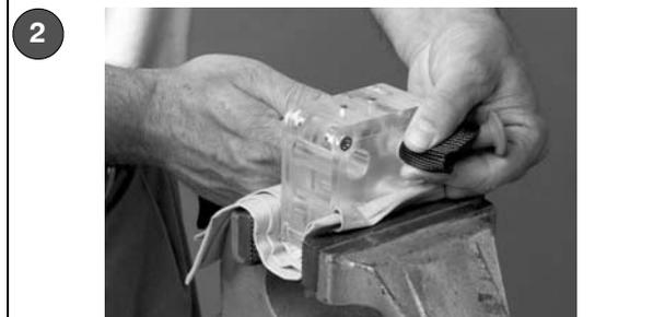
2 Insérer l'extrémité SUPÉRIEURE de la valve à étranglement dans l'outil d'insertion. Pincez l'extrémité SUPÉRIEURE et enfitez la petite extrémité dans le corps de la valve à étranglement.
