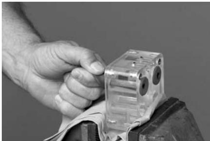
Placez le corps de la valve à étranglement dans un étau muni d'une garniture avec le dessous dirigé vers vous. Saisissez et tirez l'extrémité inférieure de la valve à étranglement d'une main.
