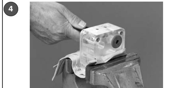
4 Tirez fermement l'outil d'insertion de la valve à étranglement jusqu'à ce que l'extrémité SUPÉRIEURE de celle-ci ainsi que la totalité de l'outil d'insertion sortent du corps de la valve.
